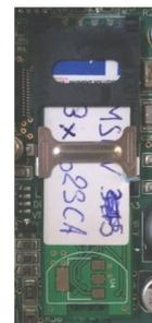
Drücken Sie nun den Halter inkl. Stick gegen die Platine und befestigen Sie den Halter mittels nach unten schieben des Metallbügels.
